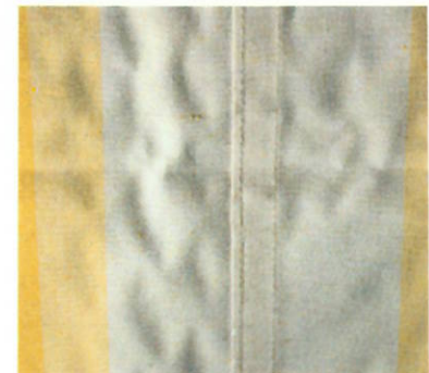
Welligkeit im Nahtbereich Waviness near stitching
